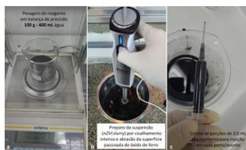
Figura 3 – Suspensão de nZVI (injeção)
